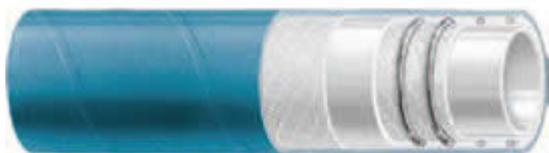
Армирование: нити из синтетического текстиля, усиление спиралью из стальной проволоки. Для обеспечения электропроводности между шлангом и концевыми присоединениями используется дополнительная медная оплетка.
