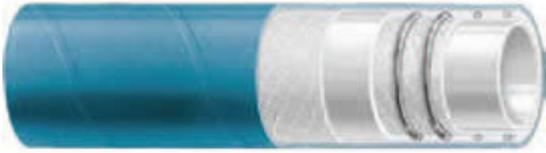
Армирование: нити из синтетического текстиля, усиление спиралью из стальной проволоки. Для обеспечения электропроводности между шлангом и концевыми присоединениями используется дополнительная медная оплетка.
