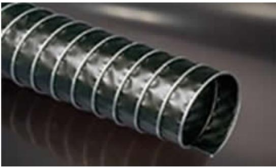
Хорошо сжимаем 1:6, улучшенная термостойкость, устойчив к к вибрации, высокая прочность на разрыв, очень гибкий, малый радиус изгиба, внешняя спираль предохраняет шланг от износа. Стенки шланга: покрытая NEOPREN-ом полиэстерная ткань. Спираль: оцинкованная стальная лента.
