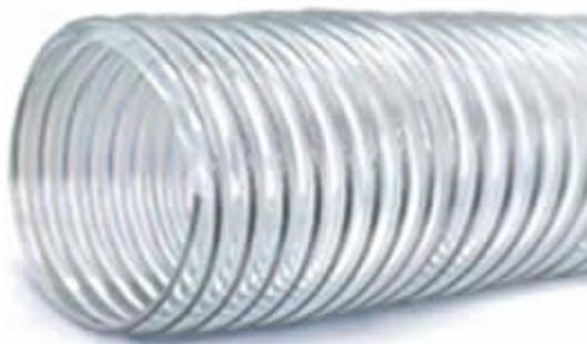
Высококачественный прозрачный полиуретан (ester) соответствует стандарту FDA, усиленный оцинкованной спиралью из пружинной стали. Толщина стенки в межвитковом пространстве 0,50 мм. Для отвода абразивных веществ (пыль, порошок, волокна, стружка, опилки), паров, содержащих масла, сварочных газов. Пригоден для пищевой, химической промышленности, деревообработки, очистных систем. По сравнению с ПВХ воздуховодами срок службы увеличен в 4-5 раз.
